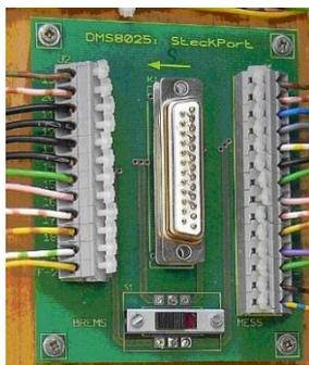
Abb. 56- Platine für Steuerungsbaustein
