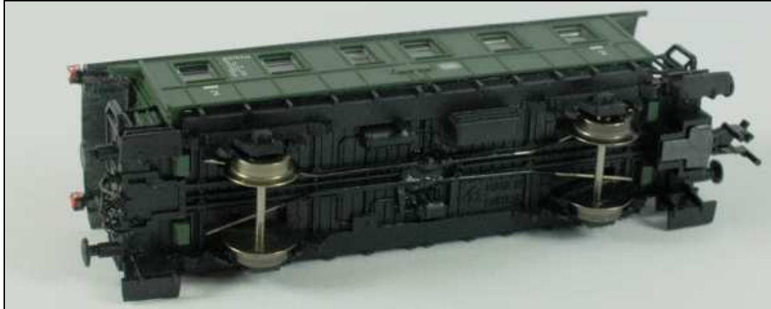
Bild 4.12: Spantenwagen mit Schleifern aus Bronze-Federdraht
