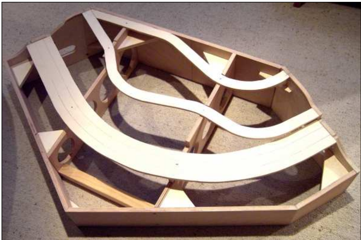
Bild 2.2: Rohkasten des Bogenmoduls
