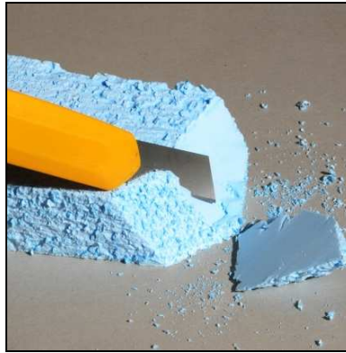
Bild 3.15: Bearbeitung mit Bastelklinge
