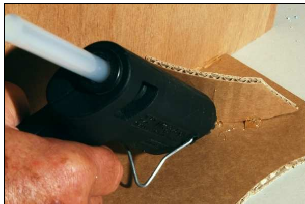
Bild 3.4: Verkleben der Kartonteile
