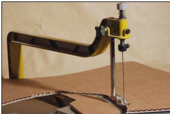
Bild 3.3: Ausschneiden der Kartonform
